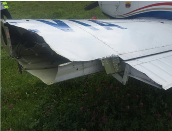
Imagen No. 1 - Daños significativos aeronave HK1598G (IZQ. Separación punta de ala – DER. Deformación bancada y estructura de tren de nariz)
