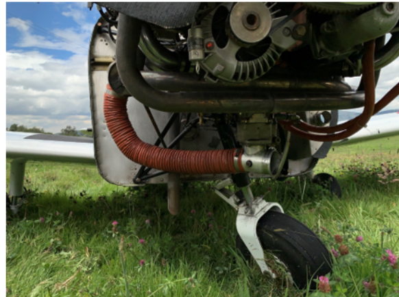
Imagen No. 1 - Daños significativos aeronave HK1598G (IZQ. Separación punta de ala – DER. Deformación bancada y estructura de tren de nariz)
